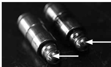
Abb.: Verschleiss auf Kugelköpfen infolge mangelhafter Ölversorgung.
